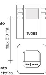
Cronotermostato digitale Wireless ECODesign + Ricevitore
