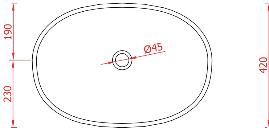
N.B. Le misure indicate possono subire una variazione dell 0,6% circa, dovuta ad usura stampi e a variazioni delle caratteristiche tecniche relative alle materie prime che compongono l'impasto .
