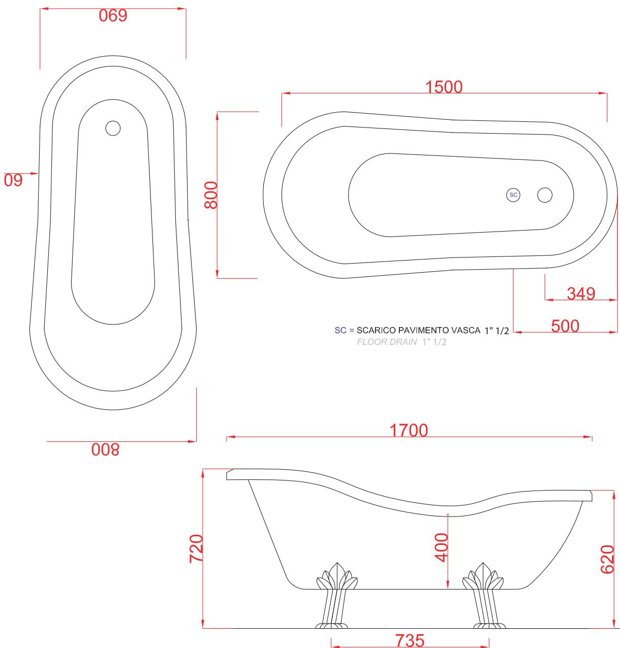
N.B. Le misure indicate possono subire una variazione dell'0,6% circa, dovuta ad usura stampi e variazioni delle caratteristiche tecniche relative alle materie prime che compongono l'impasto .
